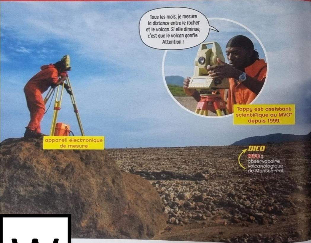
L'appareil de mesure émet un rayon qui est renvoyé par une sorte de miroir posé sur le volcan. L'appareil chronomètre alors le temps que met le rayon pour revenir et calcule donc la distance.
