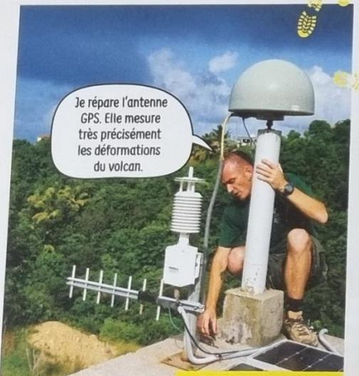
Je répare l'antenne GPS. Elle mesure très précisément les déformations du volcan.
